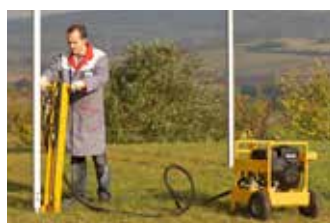
Arrache pieux hydraulique Capacité d'arrachement 3 tonnes
